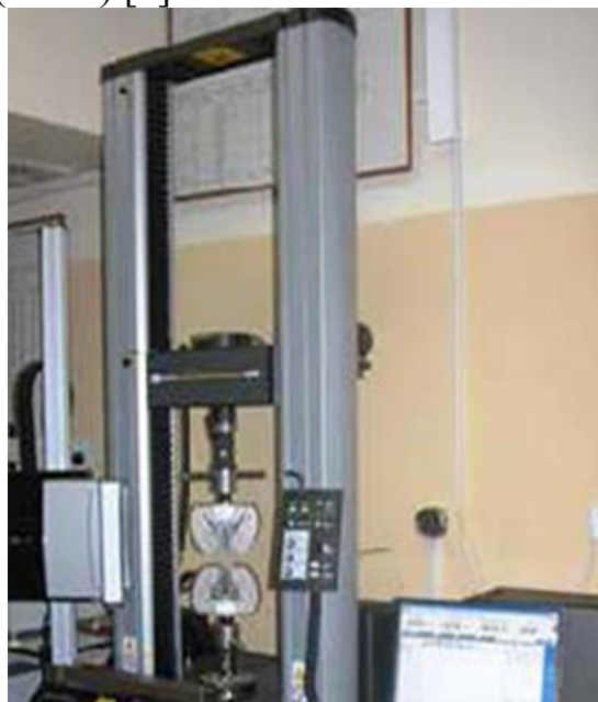
Рисунок 1 - Разрывная машина для механических испытаний.
