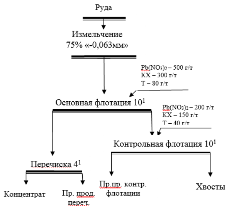
Рисунок 1. Схема проведения предварительных исследований по флотации
